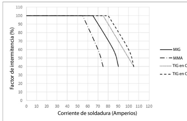
Figura 13. Ciclo de trabajo trazado para 120 V
